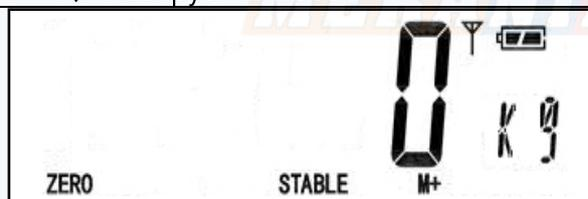
8) Для вызова из памяти суммарной массы всех трех грузов нажать кнопку **M+**, при этом на индикаторе на несколько секунд отобразится надпись «n 004», а затем суммарная масса грузов.
