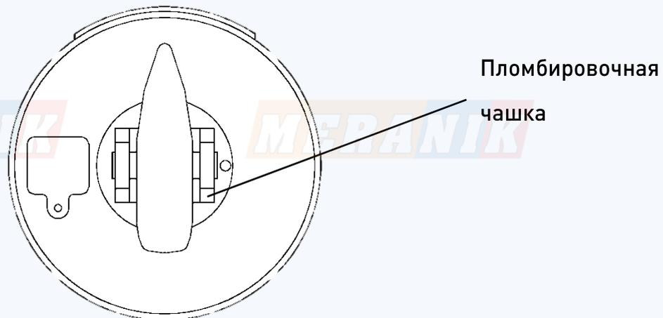
**Рисунок 4 - Место нанесения оттиска поверительного клейма.**
